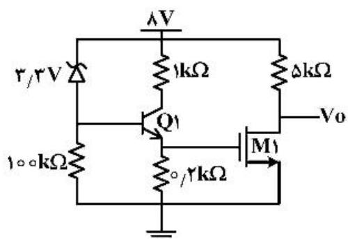
۱۰۶ - مقدار ولتاژ خروجی چند ولت است؟
