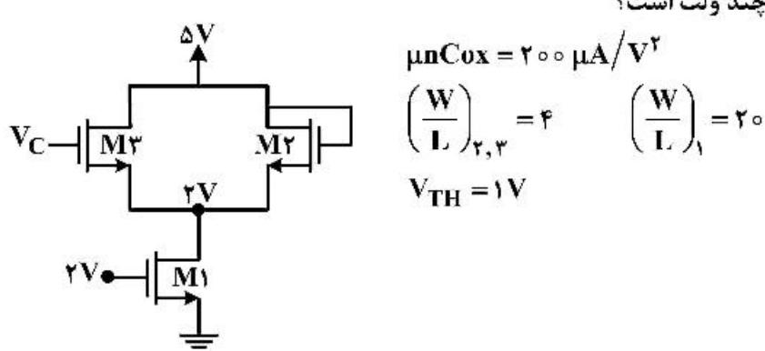
۱۰۸ - مقدار ولتاژ گیت ترانزیستور M3 چند ولت است؟
