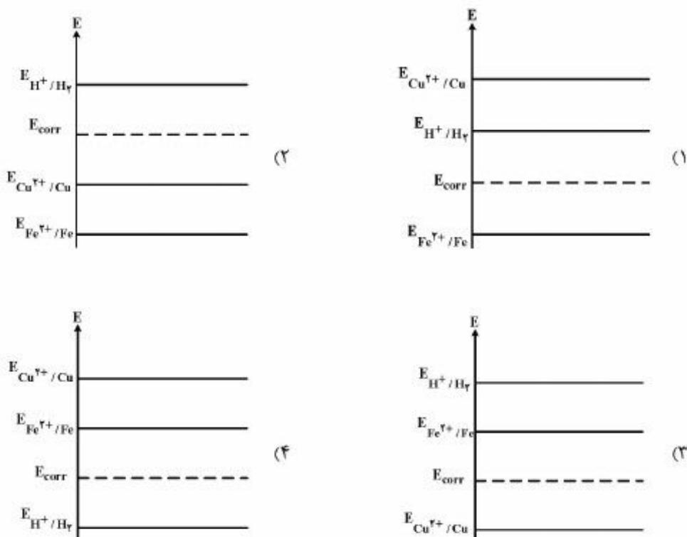
۶۵- یک لوله فولادی مورد استفاده برای انتقال آب، توسط اتصال یک قطعه منیزیم به سطح خارجی آن حفاظت کاتدی شده است. کدام مورد، در ارتباط با حفاظت این لوله از خوردگی، درست است؟
