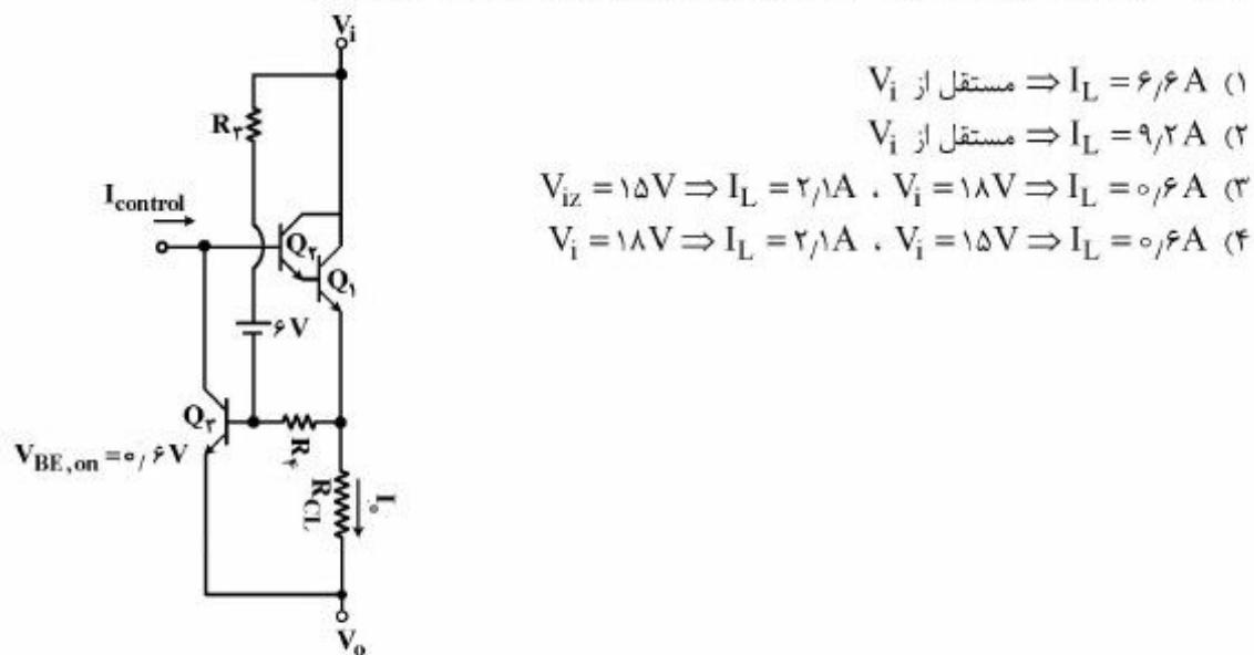
۱۳۴ - در مدار شکل زیر، به ازای  $V_s = (1/5 + 0/02 \sin(1000t))V$ ، ولتاژ خروجی کدام است؟
