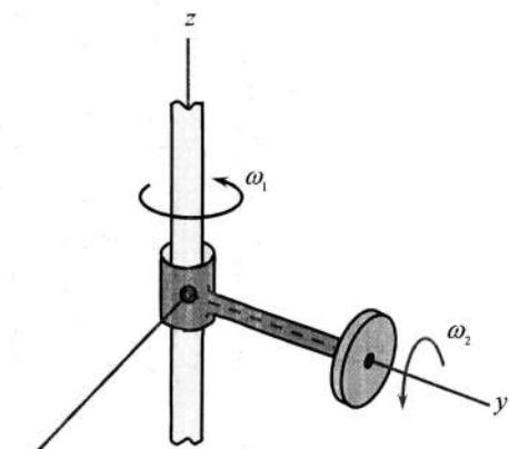
$$\vec{\alpha} = -\omega_1\omega_2\vec{i} + \dot{\omega}_2\vec{j} + \dot{\omega}_1\vec{k} \quad (1)$$
